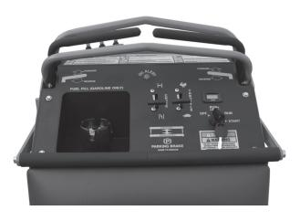
**Parking Brake Disengaged**
